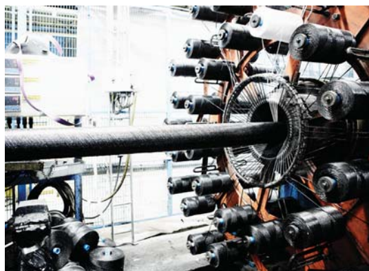
Kabeltillverkningen pågår för fullt i ABB:s fabrik. Här förses kabeln med skyddande armeringstrådar.
